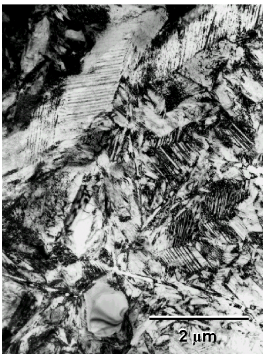
Bild 1: NiTi-Martensit im Durchstrahlungselektronenmikroskop.
